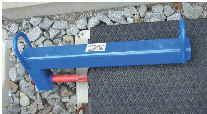
Cet outil, associé à un engin de levage, vous permet le démontage des dalles intérieures et extérieures.
