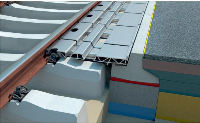
couche d'usure (asphalte coulé) avec Tok-BAND
